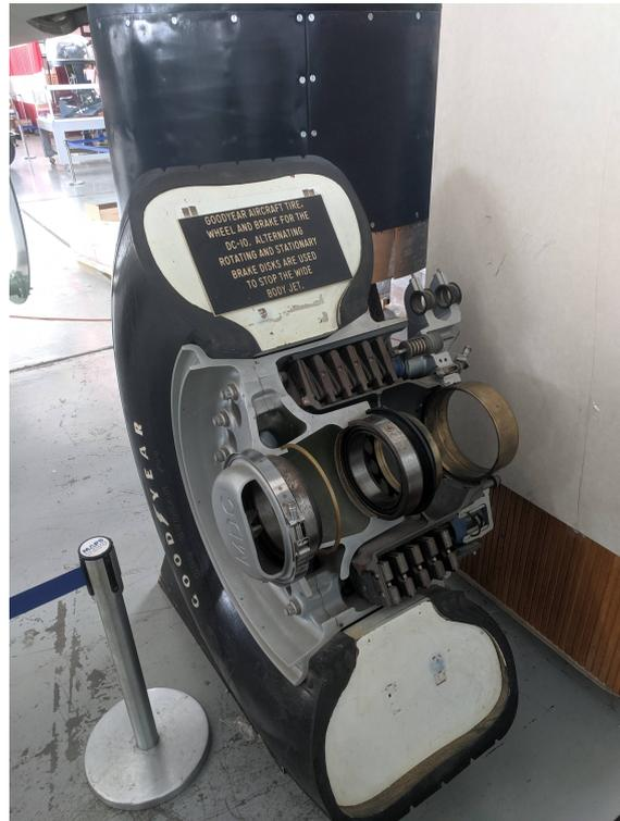
Slika 1.1: Poprečni presjek zrakoplovnog naplatka [2]
