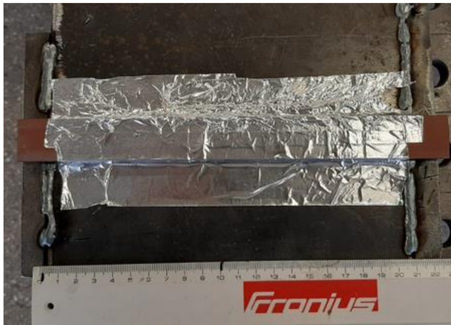
Slika 45. Prikaz pripreme spoja s korijenske strane
