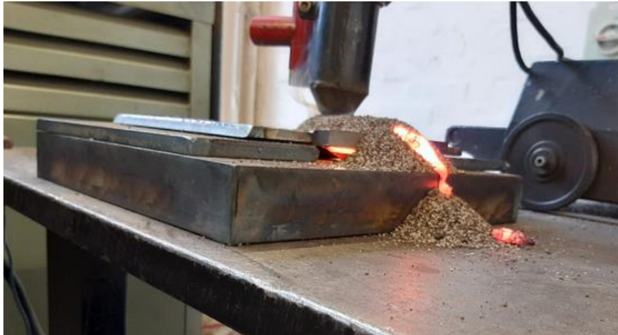
Slika 47. Proces zavarivanja uzoraka
