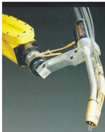
Slika 22. Pištolj za Tandem postupak zavarivanja [6]
