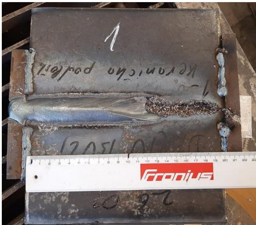
Slika 48. Uzorak B-1: lice zavara
