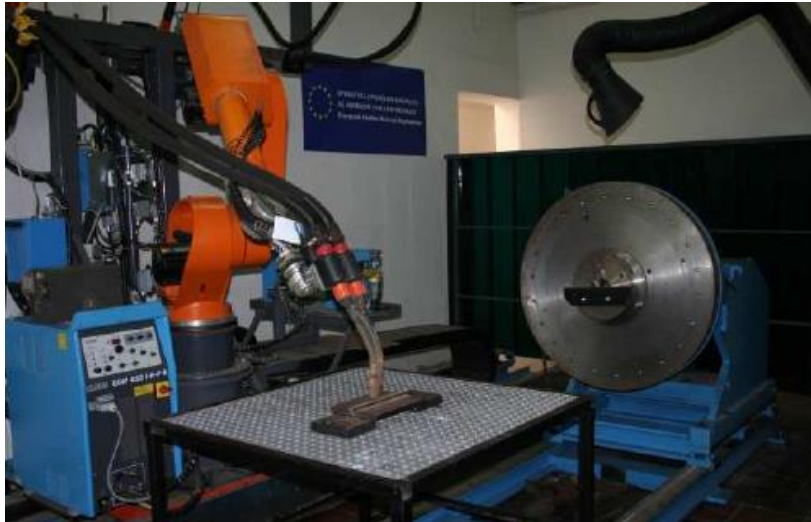
Slika 23. Robotska stanica za Tandem postupak zavarivanja [6]
