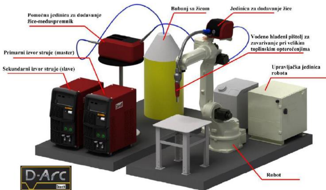
Slika 30. Robotizirani sustav za D - arc zavarivanje [4]
