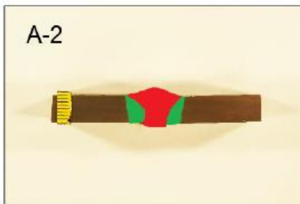
Slika 56. Zone zavara na makroizbruscima A-1 i A-2
