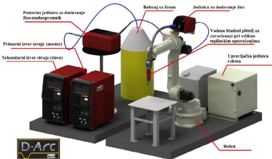
Slika 30. Robotizirani sustav za D - arc zavarivanje [4]
