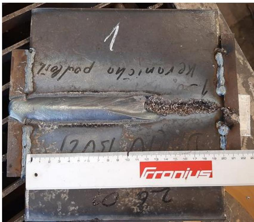
Slika 48. Uzorak B-1: lice zavara
