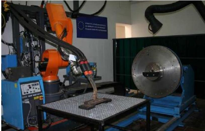
**Slika 23.      Robotska stanica za Tandem postupak zavarivanja [6]**
