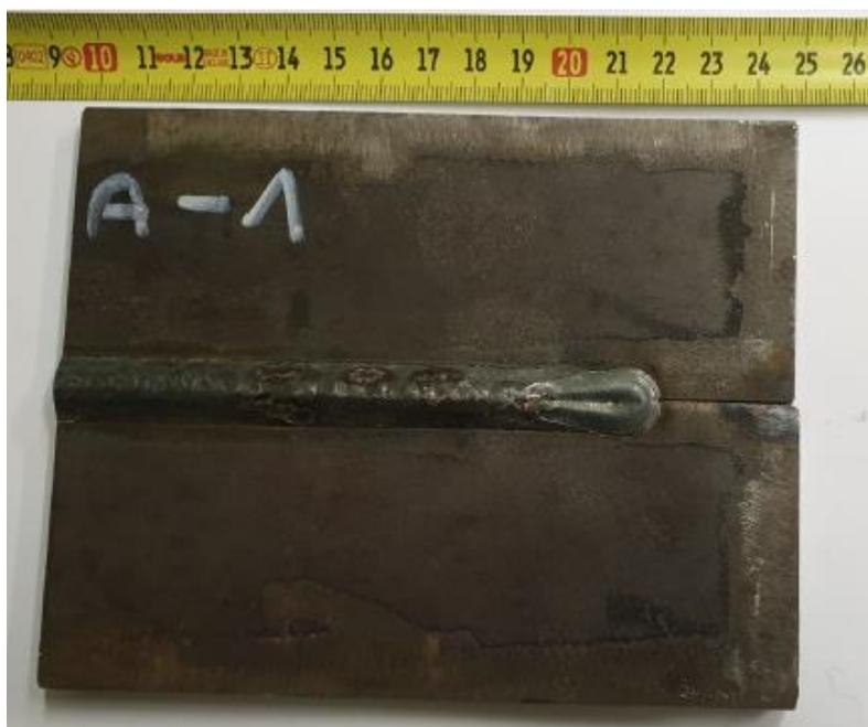
**Slika 40. Uzorak A-1 nakon postupka zavarivanja**
