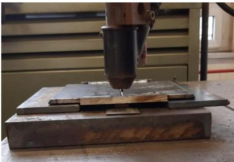
**Slika 46. Pozicioniranje elektrode**
