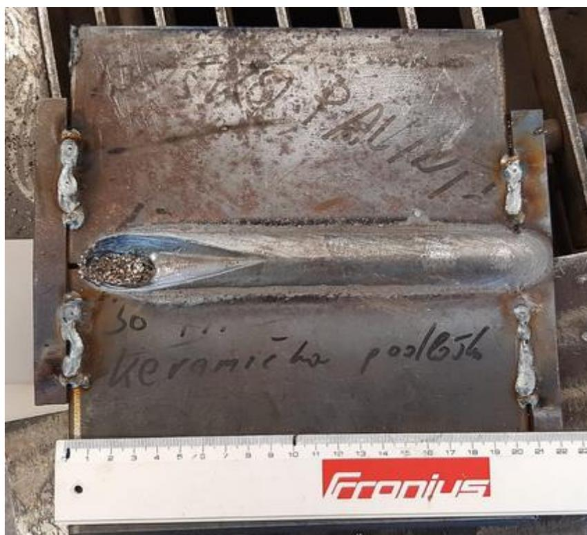
Slika 50. Uzorak B-2, lice zavara
