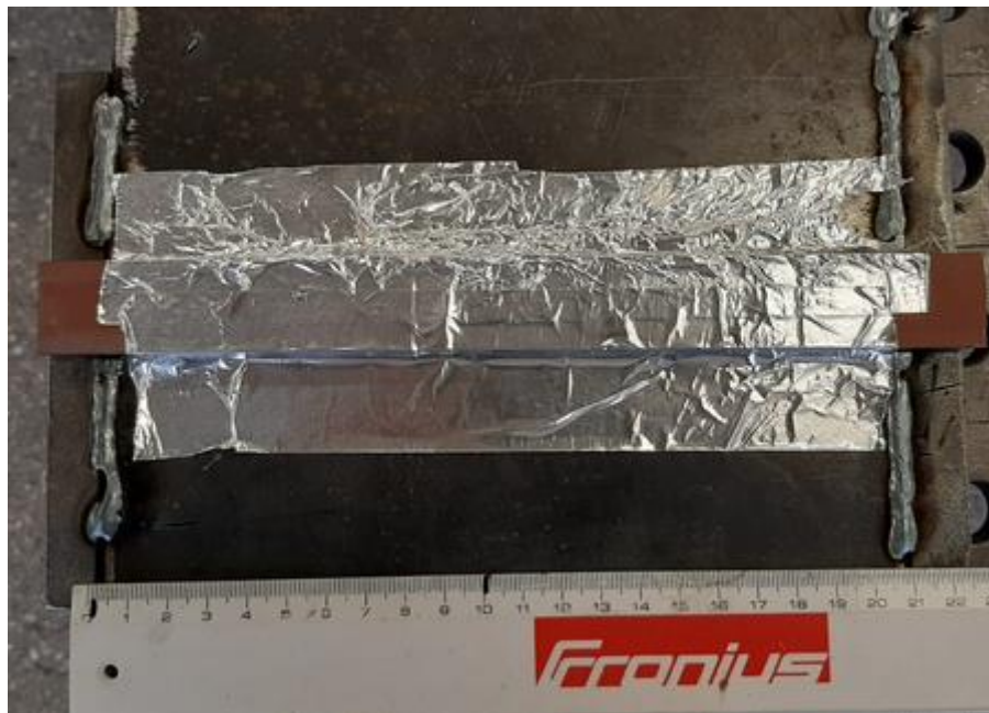
Slika 45. Prikaz pripreme spoja s korijenske strane
