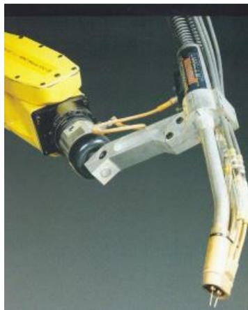
**Slika 22.** Pištolj za Tandem postupak zavarivanja [6]
