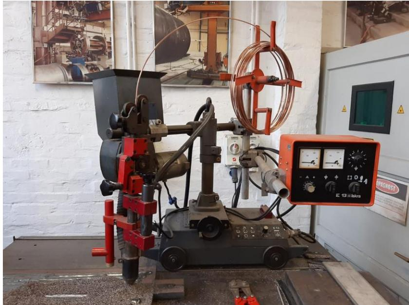
Slika 32. Mehanizam za EPP postupak zavarivanja
