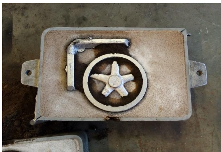
Slika 72. Prikaz odljevka u gornjaku
