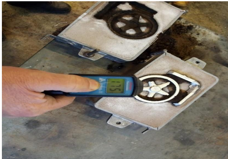
Slika 73. Mjerenje temperature odljevka beskontaktnim pirometrom nakon približno 20ak min
