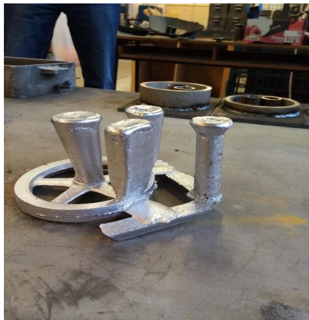
Slika 74. Odljevak sa uljevnim sustavom i pojilima na sobnoj temperaturi
