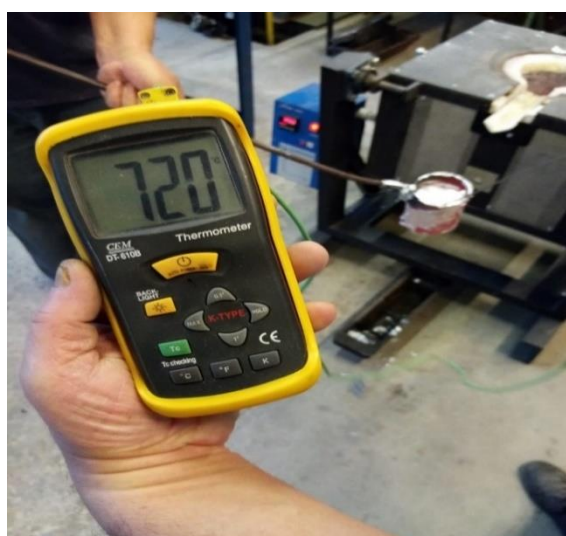
Slika 69. Mjerenje temperature u čaši kontaktnim pirometrom
