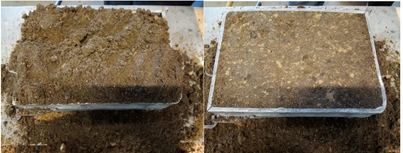
Slika 55. Dodavanje punidbene kalupne mješavine i njeno poravnavanje
