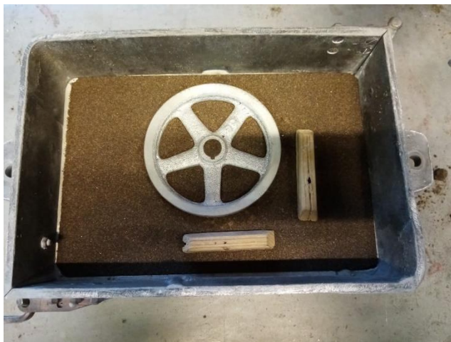
Slika 52. Model i njegovo pozicioniranje s razvodnikom u donjaku
