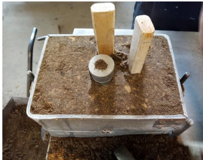
Slika 58. Zasipanje kalupnom mješavinom
