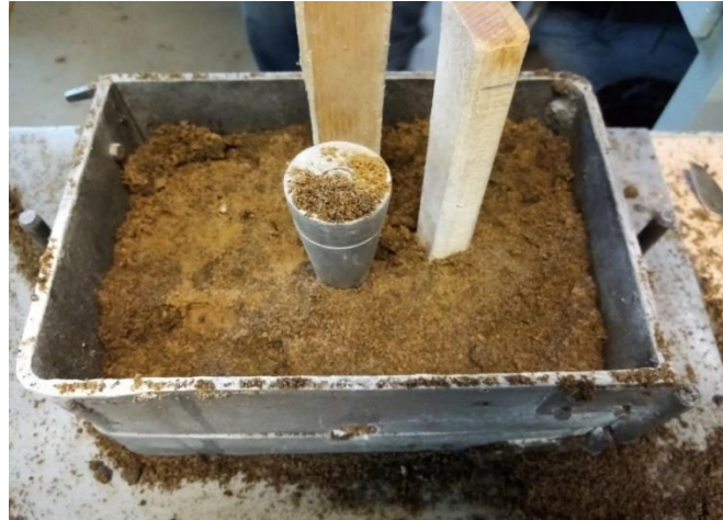
Slika 58. Zasipanje kalupnom mješavinom
