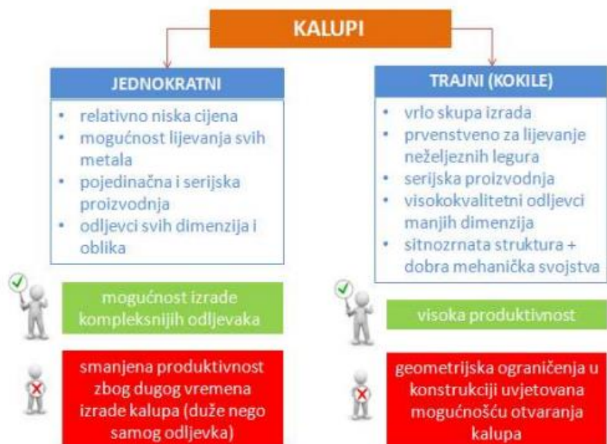
Slika 7. Karakteristike jednokratnih i trajnih kalupa [1]
