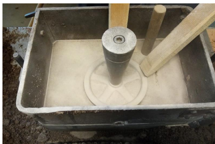
Slika 57. Postavljanje modela u gornjak i namještanje pojila te zasipavanje prahom radi lakšeg vađenja
