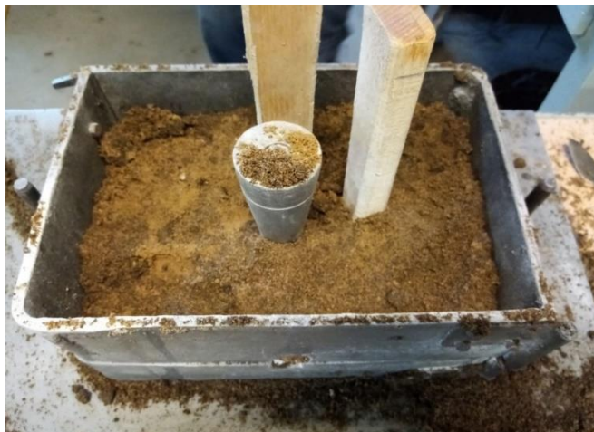
Slika 58. Zasipanje kalupnom mješavinom
