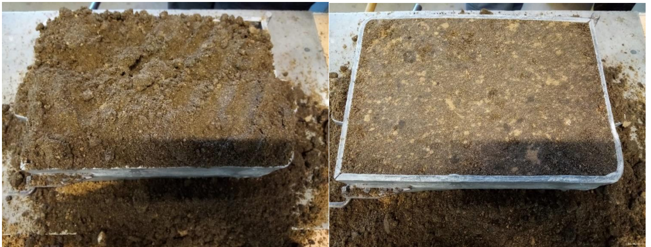
Slika 55. Dodavanje punidbene kalupne mješavine i njeno poravnavanje
