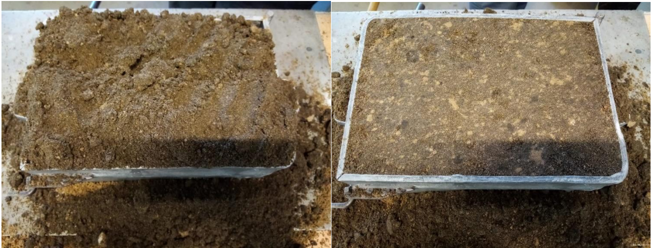
Slika 55. Dodavanje punidbene kalupne mješavine i njeno poravnavanje
