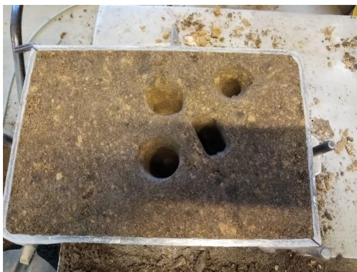
Slika 65. Spojen gornjak i donjak te skošenje rubova lancetom
