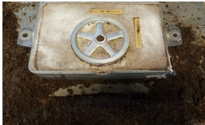
Slika 56. Model odljevka i razvodnik u donjaku
