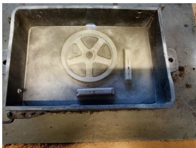
Slika 53. Zasipavanje donjaka prahom radi lakšeg vađenja modela
