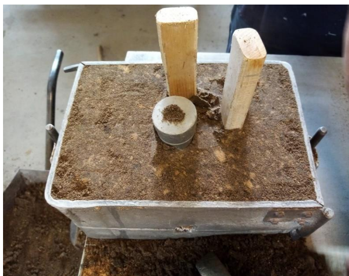
Slika 58. Zasipanje kalupnom mješavinom
