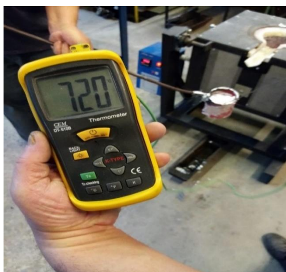
Slika 69. Mjerenje temperature u čaši kontaktnim pirometrom
