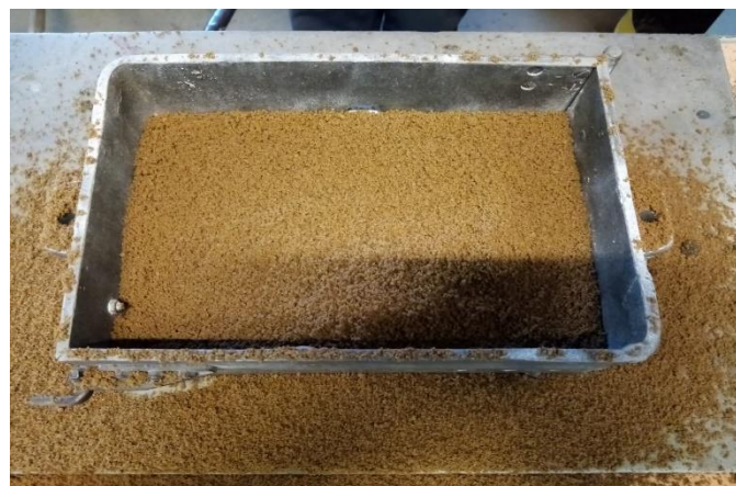
Slika 54. Zasipavanje donjaka modelnom kalupnom mješavinom
