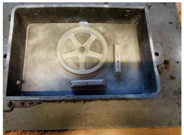
Slika 53. Zasipavanje donjaka prahom radi lakšeg vađenja modela
