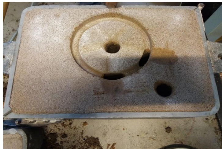
Slika 64. Kalupna šupljina u gornjaku ( lancetom je izrađeno ušće )
