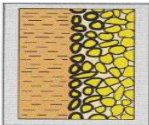
Slika 12. Prikaz zrnaca koji su zaštićeni sjajnim ugljikom[5]
