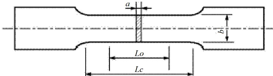
Slika 4.3. Uzorak uzdužno izrezane trake [3]
