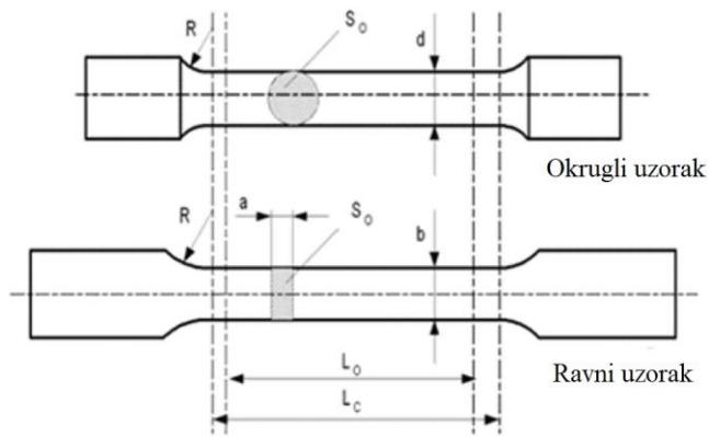
Slika 4.1. Uzorci za vlačno ispitivanje (okrugli i plosnati) [3]
