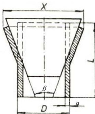
**Slika 4.6. Ispitivanje proširivanjem [3]**
