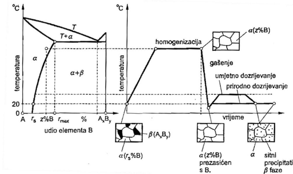
Slika 3.1. Prikaz općeg postupka precipitacijskog očvršćivanja [4]
