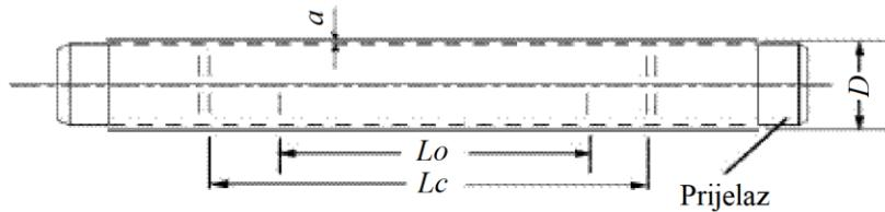
Slika 4.2. Uzorak punog presjeka s začepljenim krajevima [3]
