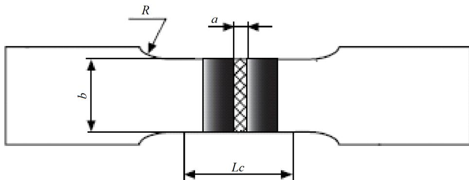
Slika 4.4. Uzorak za statičko vlačno ispitivanje čeonog zavara [3]
