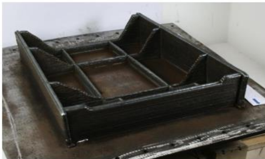
Slika 9. Rebro izrađeno WAAM postupkom [3]
