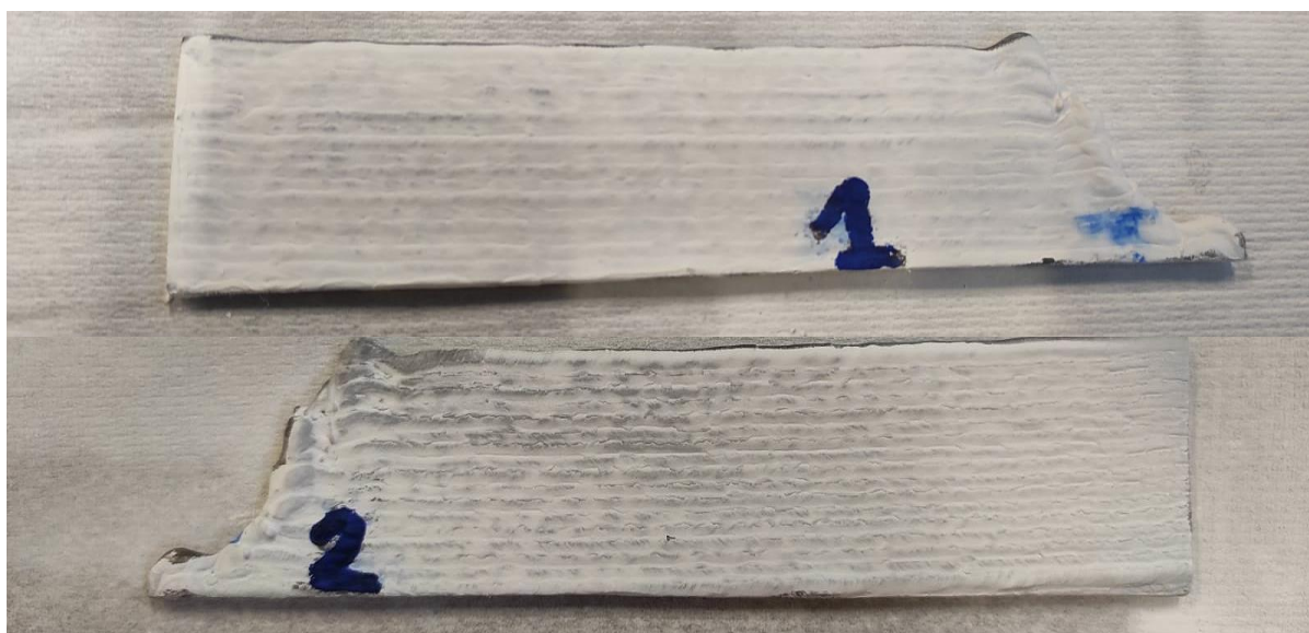
Slika 52. Obje strane zida nanosene penetrantom SKD – S2
