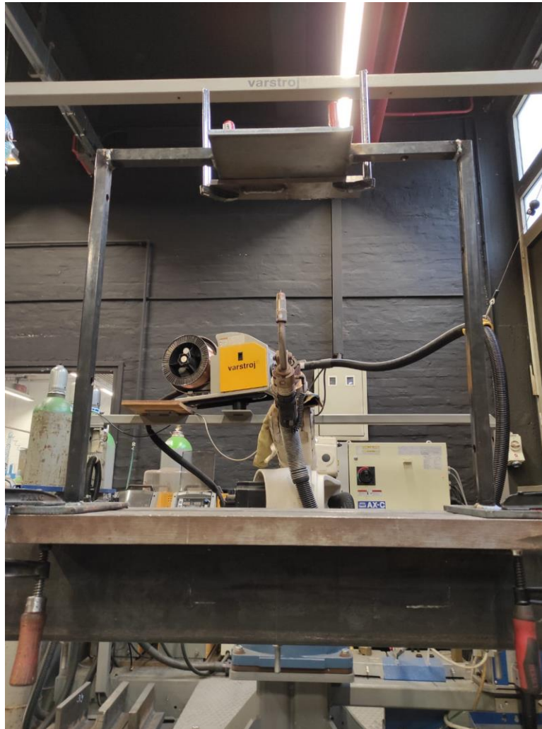
Slika 43. Prikaz stezanja postolja za nadglavno zavarivanje na radnu površinu robotske stanice
