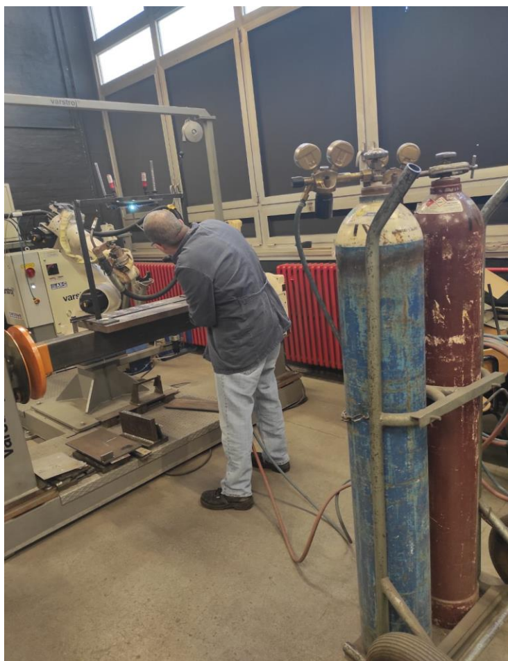
Slika 47. Predgrijavanje podloge i zida
