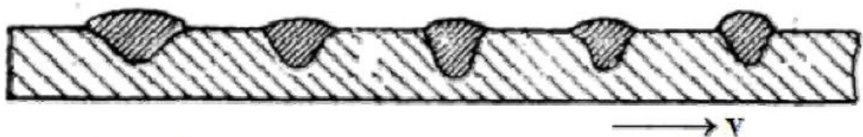
Slika 19. Utjecaj brzine zavarivanja na oblik zavara [11]
