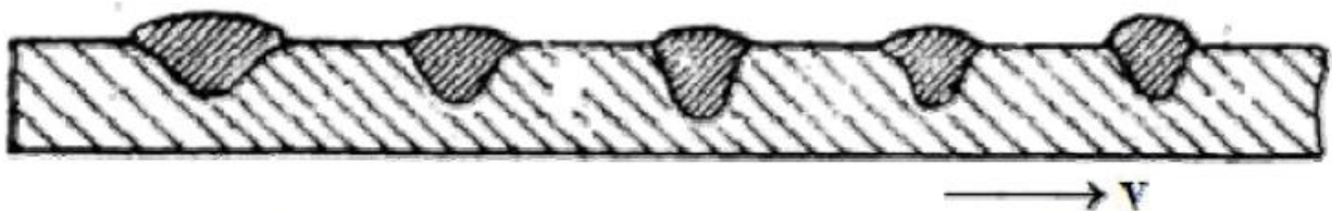
Slika 19. Utjecaj brzine zavarivanja na oblik zavara [11]
