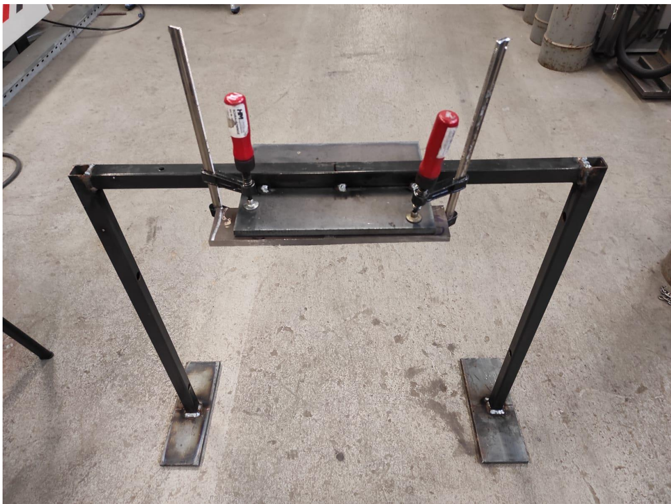
Slika 42. Postolje za nadglavno zavarivanje
