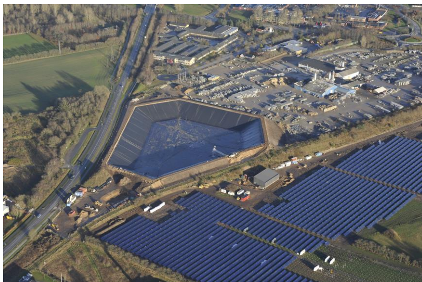
Slika 13. Polje kolektora i sezonski spremnik u Vojensu [23]
