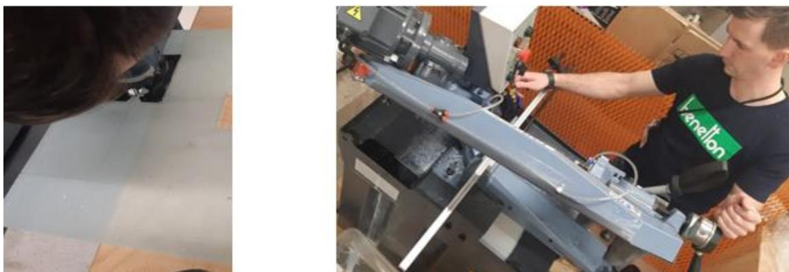
Slika 7.21. Rezanje pleksiglasa na gabaritne mjere (lijevo) i rezanje aluminijskih profila na definirane dimenzije (desno)
