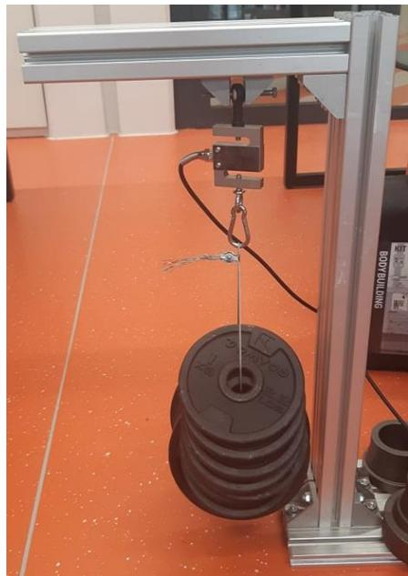
Slika 7.13. Testni postav senzora sile sa senzorom sile
