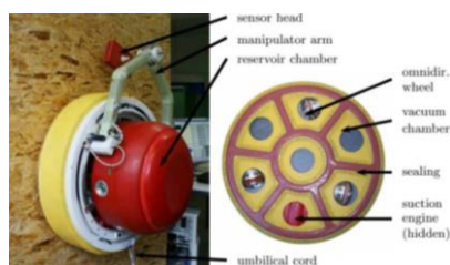
Slika 1.4. CROMSCI robot, adhezija negativnim tlakom [8, p. 4]
