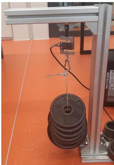
Slika 7.13. Testni postav senzora sile sa senzorom sile
