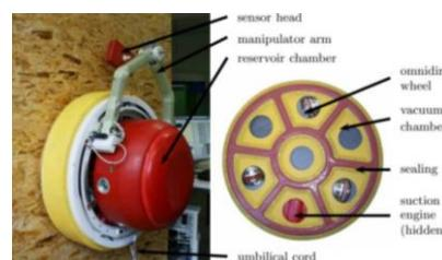
*Slika 1.4. CROMSCI robot, adhezija negativnim tlakom [8, p. 4]*
