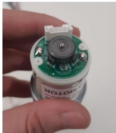
*Slika 4.14. Hall efekt senzori na motoru*
