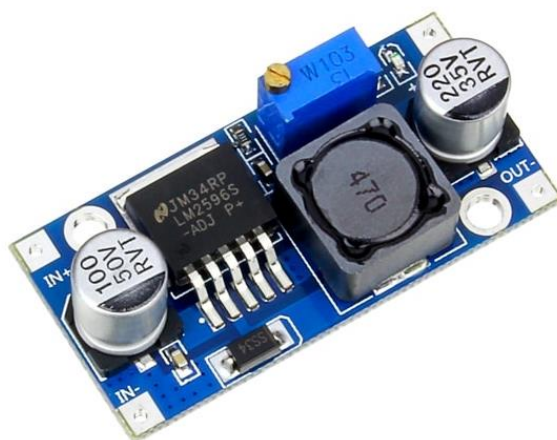
Slika 4.20. Regulator napona LM2596S[27]
