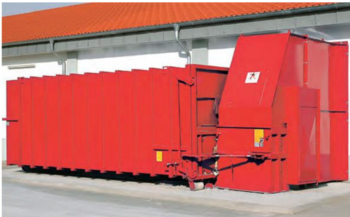
Slika 2.1. PRESTO statički pužni kontejner [4]
