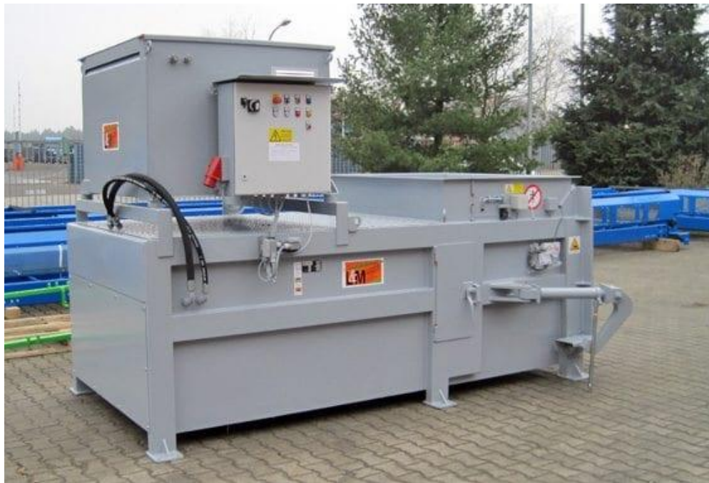
Slika 2.4. unoTech statički kompaktor [7]
