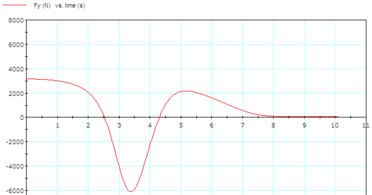
Slika 89: Sile na spoju pomoćne poluge s glavnim nosačem
