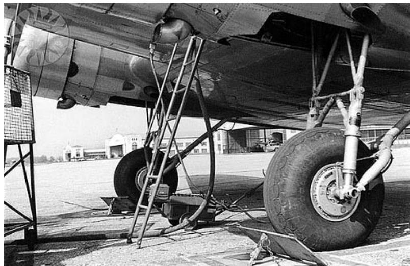
Slika 15: Stajni trap Douglas DC-2
