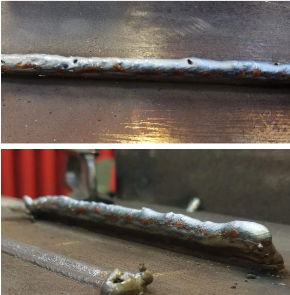
Slika 14. Gore – poroznost, dolje – nadvišenje na početku zavarivanja
