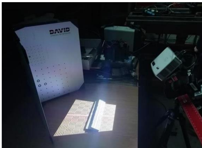
Slika 31. Prikaz postupka 3D skeniranja
