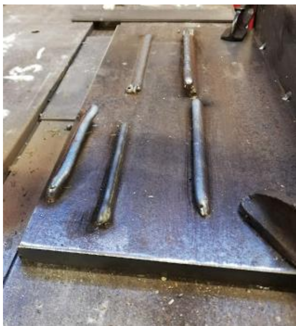
Slika 13. Probe izrade kosih zidova različitim parametrima zavarivanja
