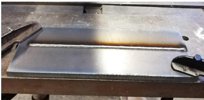
Slika 17. Prvi prolaz zida nazivnog kuta 60^\circ
