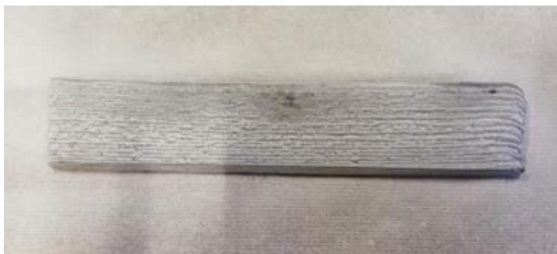
Slika 30. Pripremljen uzorak za ispitivanje površine i razvijaa Magnaflux SKD-S2
