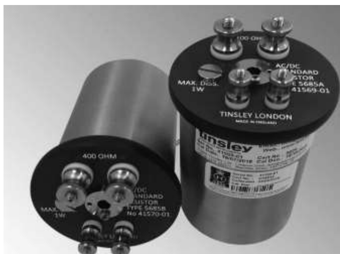
Slika 10. Fiksni otpornik Tinsley 5685 A, 100\ \Omega
