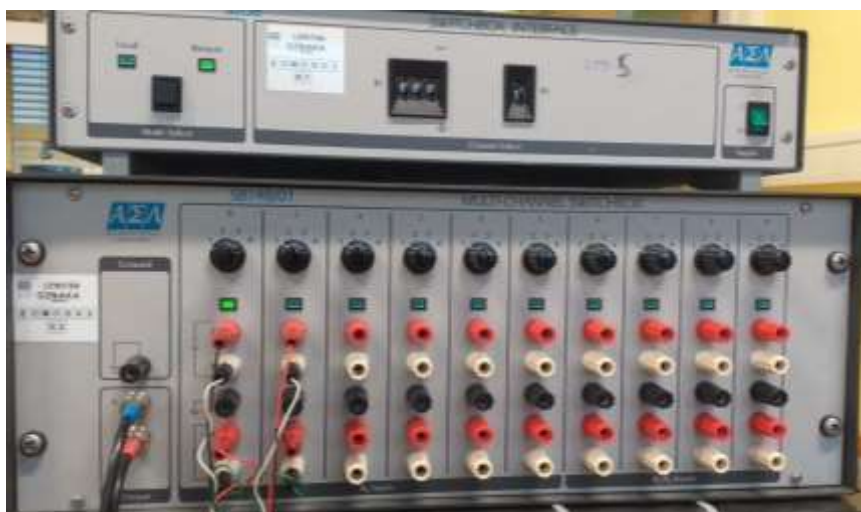
Slika 9. Multipleksor sa spojenim termometrima
