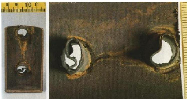
Slika 2.6 Primjer puknuća cijevi zbog djelovanja kontaktne korozijske [5]
