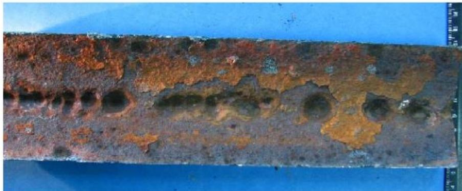
Slika 2.7 Oštećenje cjevovoda zbog djelovanja jamičaste korozije [5]
