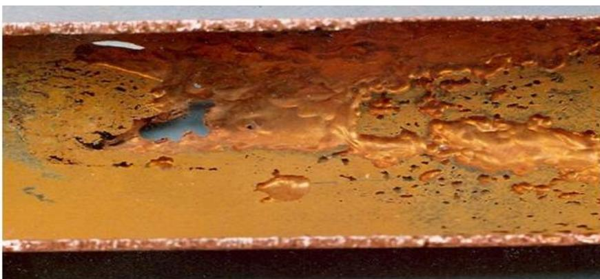
Slika 2.9 Erozijsko trošenje bakrene cijevi [8]
