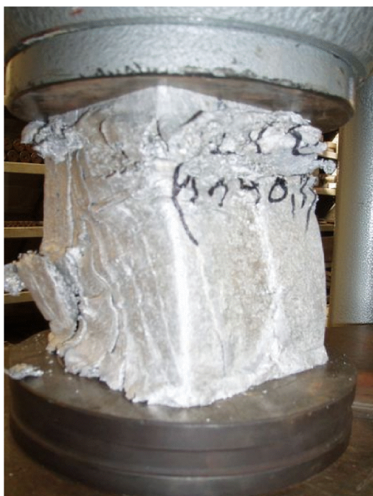
Slika 6.16. Urušavanje ćelija pod utjecajem tlačne sile rezultira kontrakcijom visine uzorka.
