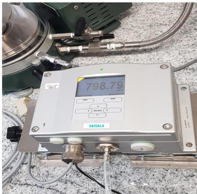
Slika 23. Digitalni barometar Vaisala, PTB330
