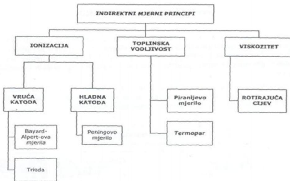
Slika 5. Indirektne metode mjerena tlaka
