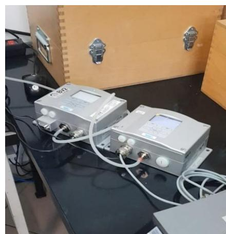
**Slika 26. Referentni uređaj (lijevo) i umjeravani uređaj (desno)**
