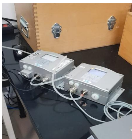
Slika 26. Referentni uređaj (lijevo) i umjeravani uređaj (desno)
