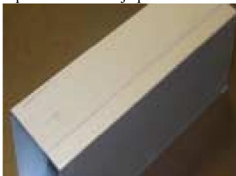
Slika 52. Ogrobotina na ekstrudiranom profilu [26]
