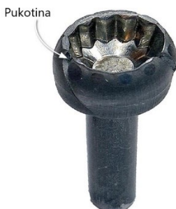
Slika 45. Površinska pukotina nastala tijekom hladnog kovanja [21]
