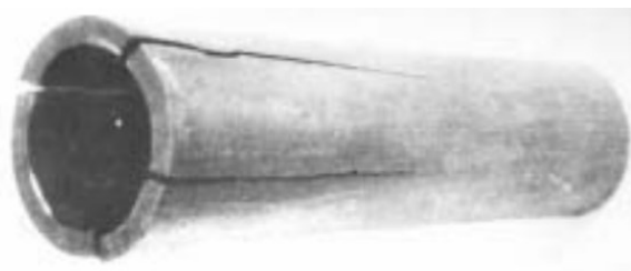
Slika 40. Pukotine uzrokovane unutarnjim naprezanjima [15]
