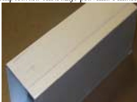
Slika 52. Ogrobotina na ekstrudiranom profilu [26]
