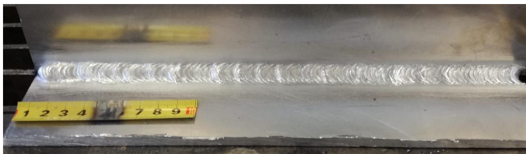
Slika 30. Vizualno pregledana površina (lice) zavara
