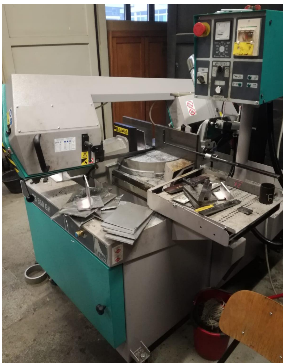
Slika 33. Tračna pila korištena za strojno rezanje makroizbrusaka
