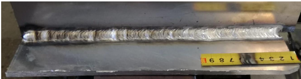
Slika 29. Zavar izveden MIG postupkom duplim pulsom
