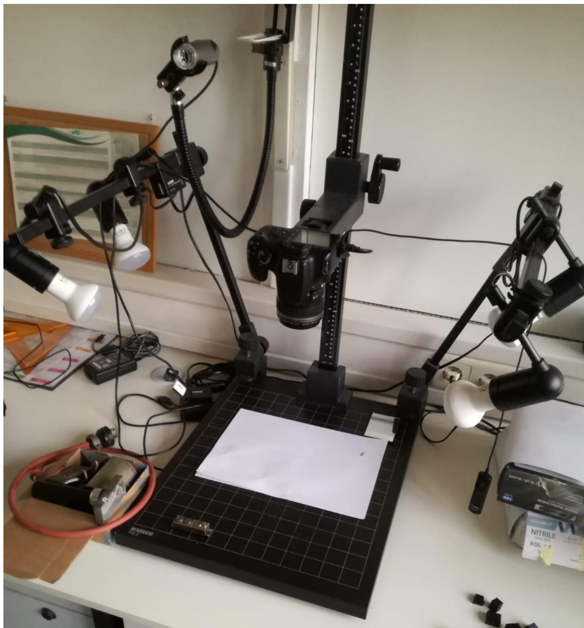
Slika 36. Područje za slikanje makroizbrusaka
