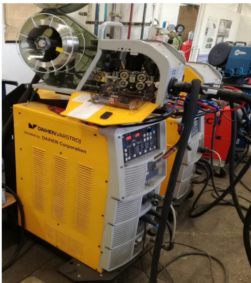
Slika 26. Uređaj za zavarivanje, Welbee P500L, Daihen Varstroj
