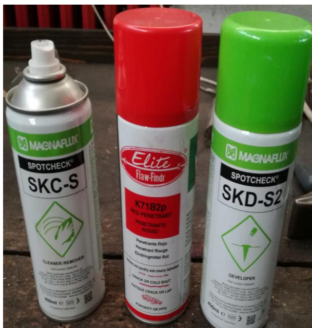
Slika 31. Sredstva korištena za ispitivanje penetrantima
