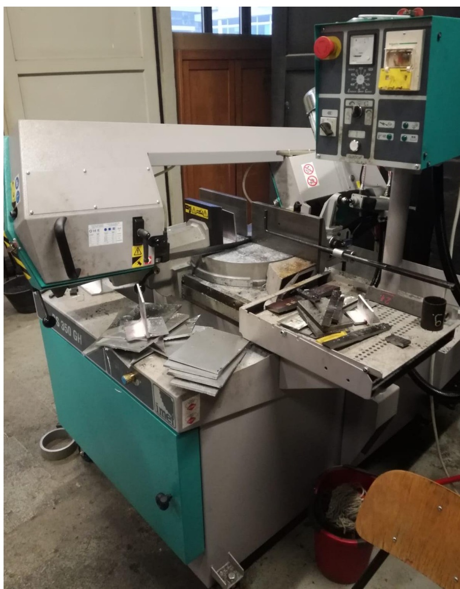
Slika 33. Tračna pila korištena za strojno rezanje makroizbrusaka
