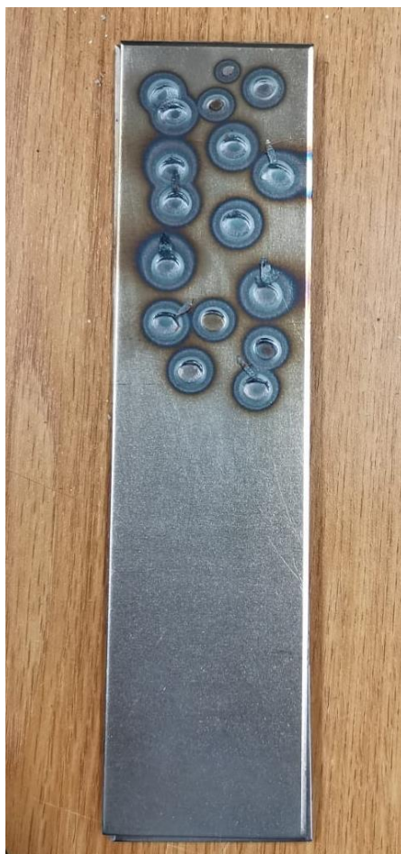
Slika 47 Predeksperiment – optimiranje parametara zavarivanja
