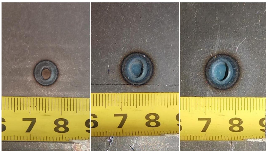
Slika 50 Uvećani prikaz zavara ispitnih uzoraka 1, 2 i 3 (s lijeva na desno)
