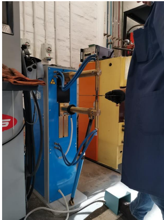
Slika 49 Zavarivanje ispitnih uzoraka
