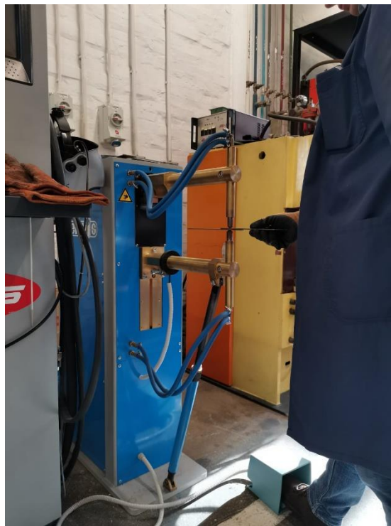
Slika 49 Zavarivanje ispitnih uzoraka
