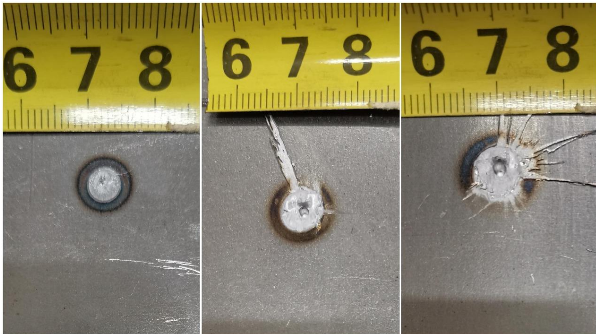
Slika 58 Uvećani prikaz mjesta loma ispitnih uzoraka 1, 2 i 3 (s lijeva na desno)
