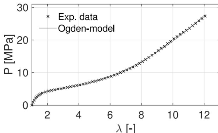
Slika 10. Graf preklapanja stvarnog dijagrama naprezanja-istezanja i odgovarajućeg Ogden modela u Abaqus simulaciji. [17]
