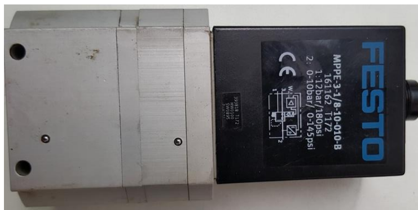
Slika 33. Proporcionalni regulator tlaka FESTO MPPE-3-1/8-10-010-B [2]
