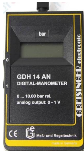
Slika 31. Digitalni manometar Greisinger digital manometer GDH 14
