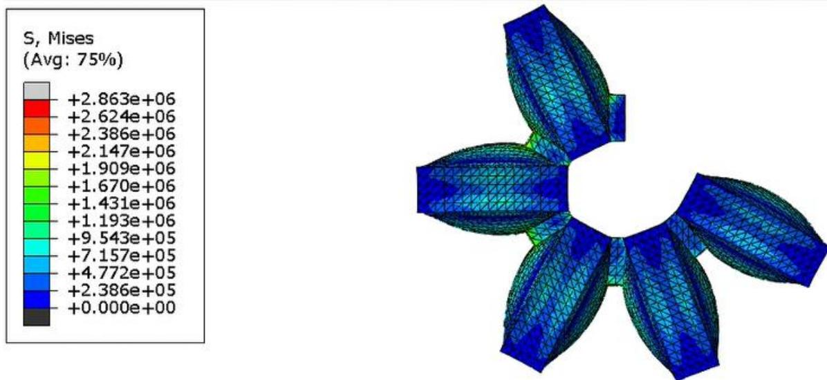
Slika 21. Prikaz rezultata naprezanja i deformacije za model 3 kod 0.5 bara
