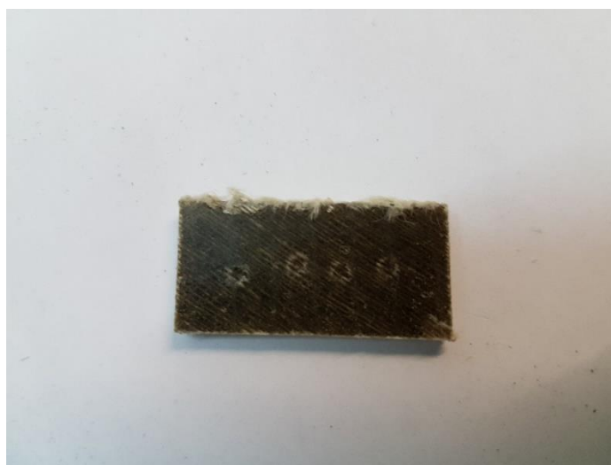
Slika 17. Ispitna pločica nakon provedenog ispitivanja tvrdoće
