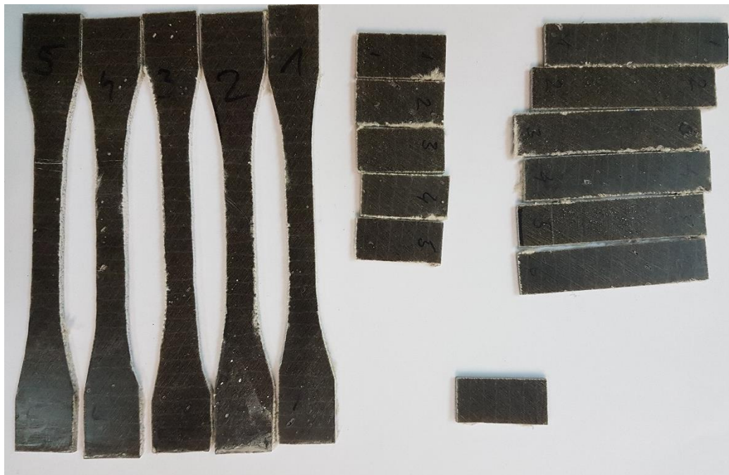
Slika 16. Uzorci za ispitivanje mehaničkih svojstava: lijevo je uzorak za rastezna svojstva, u sredini za prividnu smičnu međuslojnu čvrstoću i desno za savojna svojstva.
