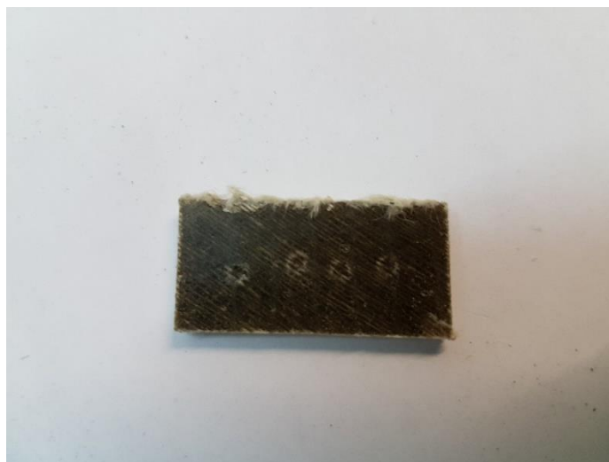
Slika 17. Ispitna pločica nakon provedenog ispitivanja tvrdoće
