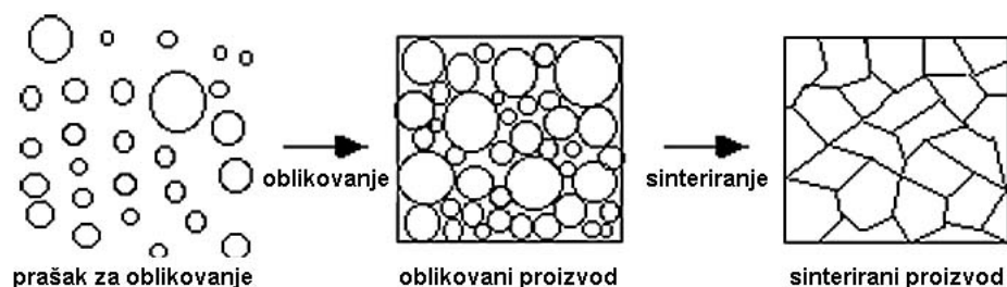
Slika 7. Zgušnjavanje mase oblikovanjem za daljnu obradu (sinteriranje [4])
