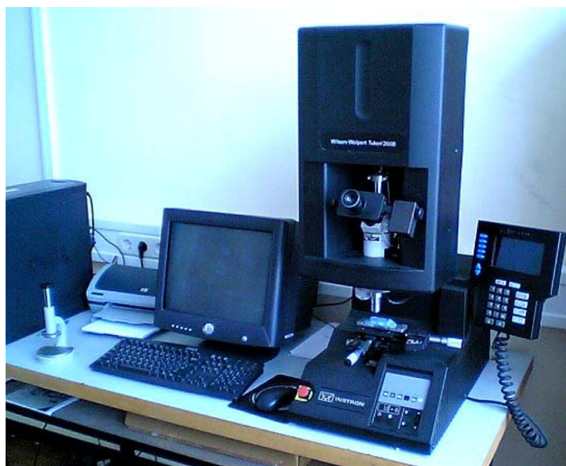
Slika 30. Mirkotvrdomijer Instron, Wilskon-Wolpert Tukon 2100B
