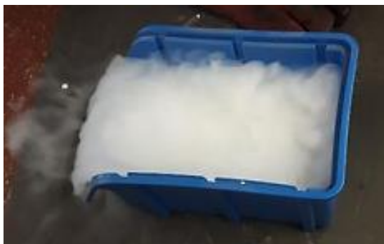
Slika 4.7. Hlađenje pomoću suhog leda i alkohola
