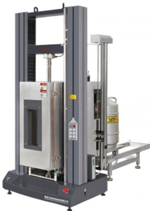
Slika 3.8. Komora za ohlađivanje ugrađena na kidalicu [5]
