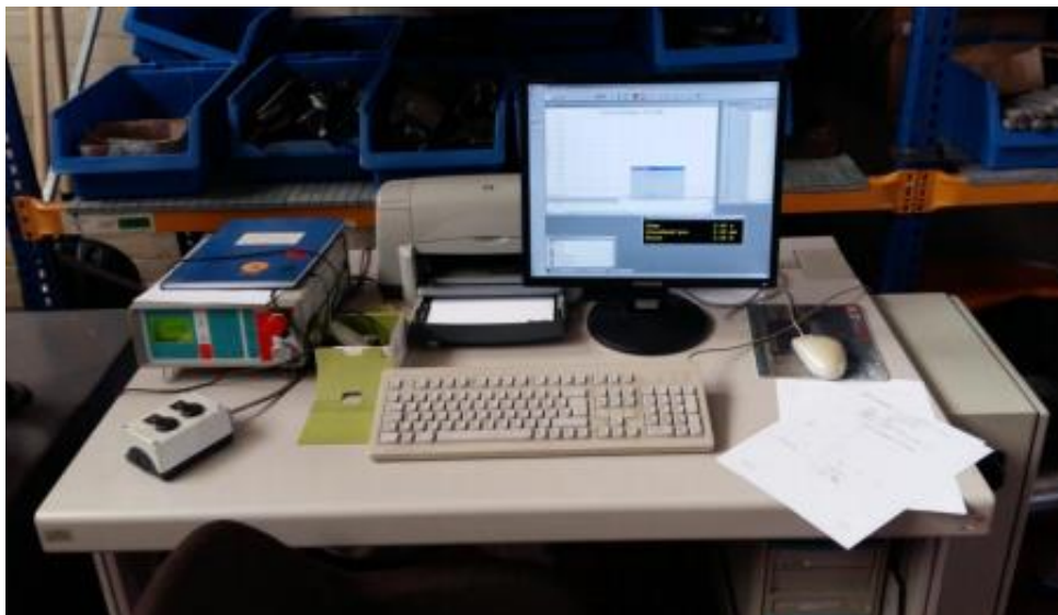
Slika 4.3. Računalo s TireTest programom spojenim na kidalicu
