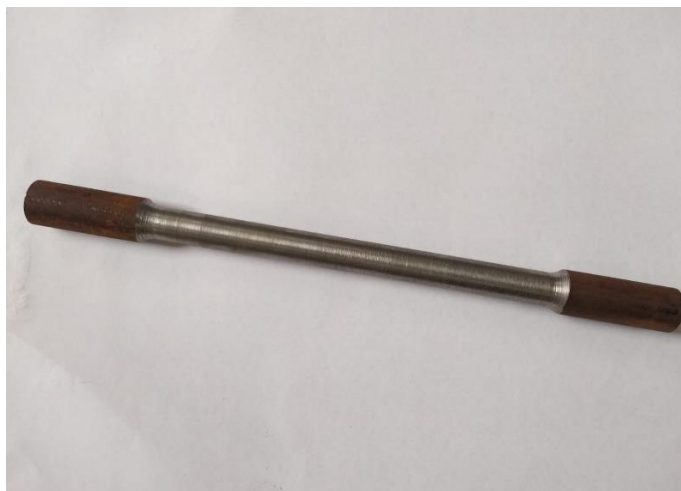
Slika 4.1. Epruveta za statičko vlačno ispitivanje na sniženim temperaturama
