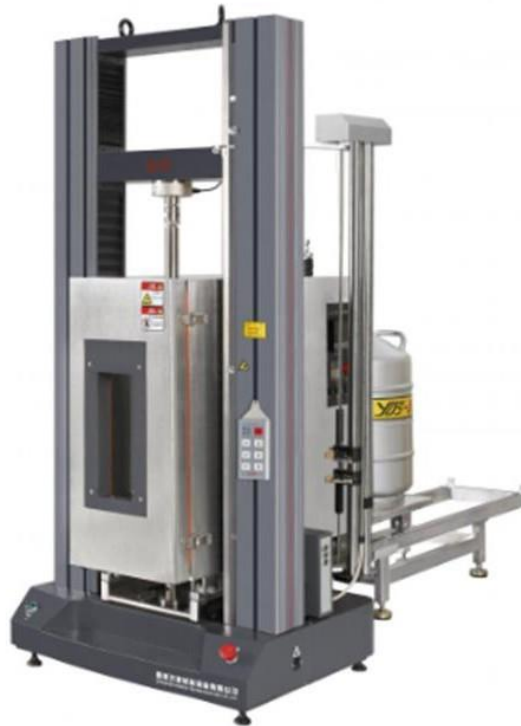
Slika 3.8. Komora za ohlađivanje ugrađena na kidalicu [5]
