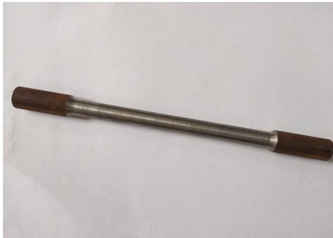
**Slika 4.1. Epruveta za staticko vlačno ispitivanje na sniženim temperaturama**
