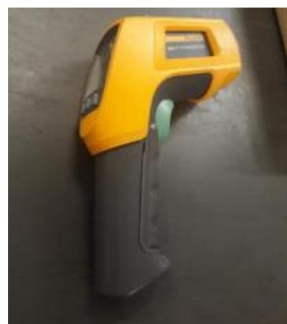
Slika 4.6. Fluke 568 IR Thermometer
