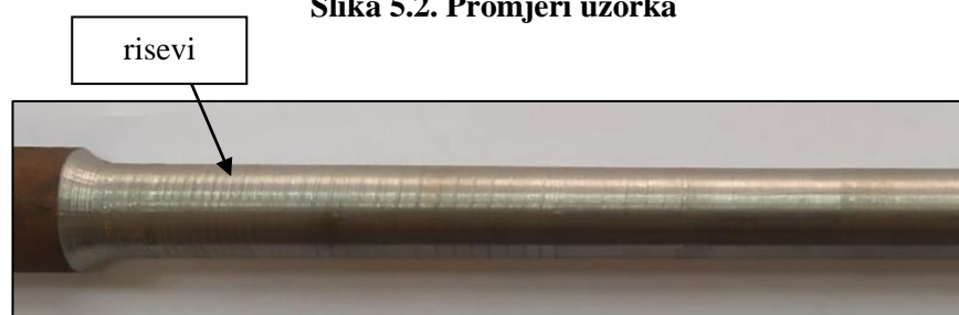
Slika 5.3. Oštećenja na ispitnom uzorku
