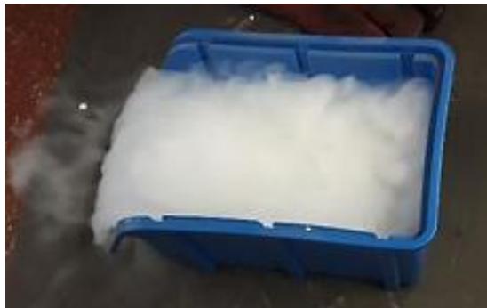
Slika 4.7. Hlađenje pomoću suhog leda i alkohola
