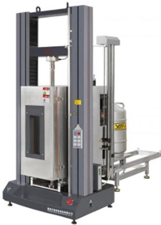
**Slika 3.8. Komora za ohlađivanje ugrađena na kidaliciu [5]**
