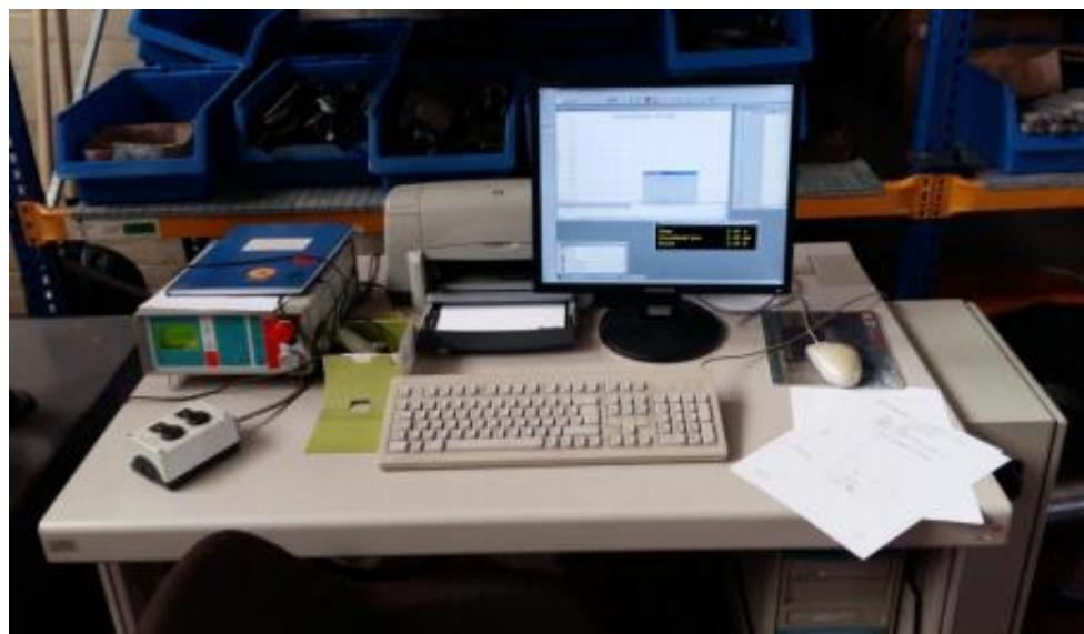
Slika 4.3. Računalo s TireTest programom spojenim na kidalicu
