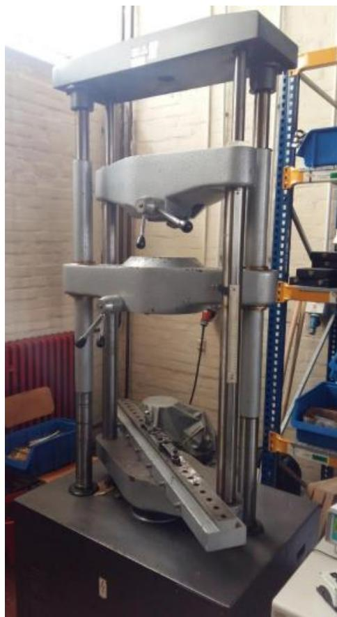
**Slika 4.2. Hidraulična kidalica WPM EU 40 MOD**
