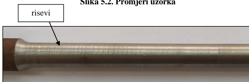
Slika 5.3. Oštećenja na ispitnom uzorku
