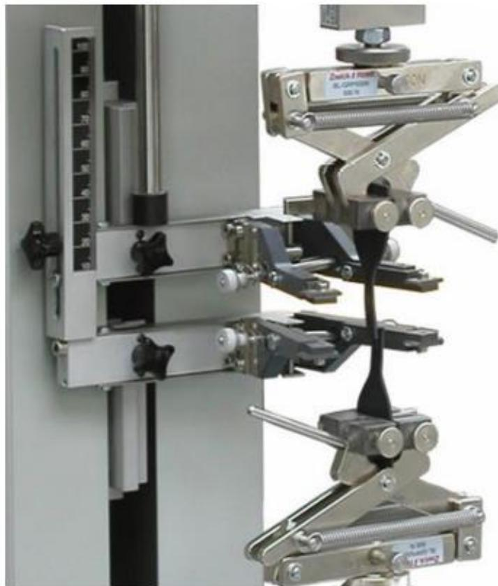
Slika 2.3. Automatski ekstenzometar [5]
