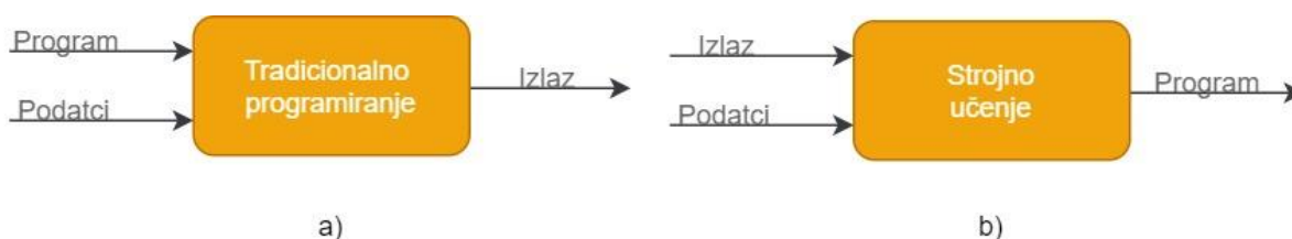
Slika 2.1. Razlika između a) tradicionalnog programiranja i b) strojnog učenja
