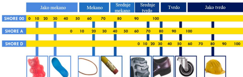
Slika 39. Skala tvrdoće po Shore-u [48]
