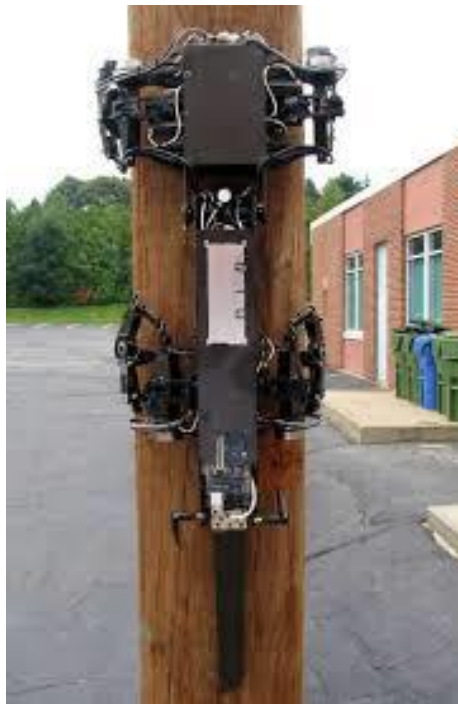
Slika 10. RiSE v3 robot penjač [13]
