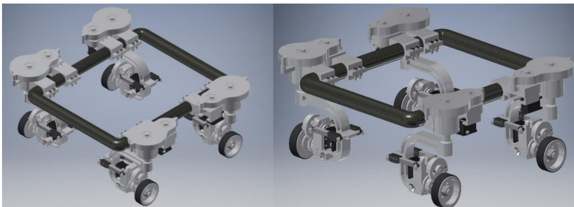
Slika 53. Kopčanje modula s vanjske strane cijevne konstrukcije robota gabarita 400 x 500 mm
