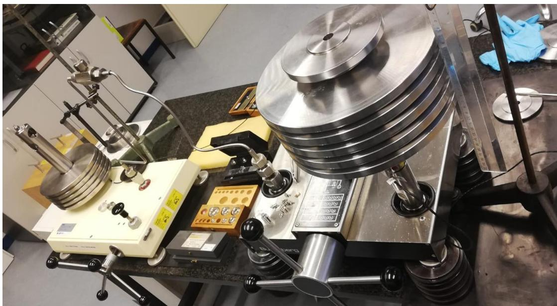
**Slika 11. Sklop ispitivane i etalonske vase**
