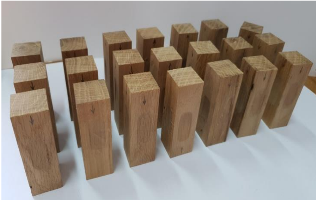
Slika 25 Uzorci za ispitivanje otpornosti na abrazijsko trošenje
