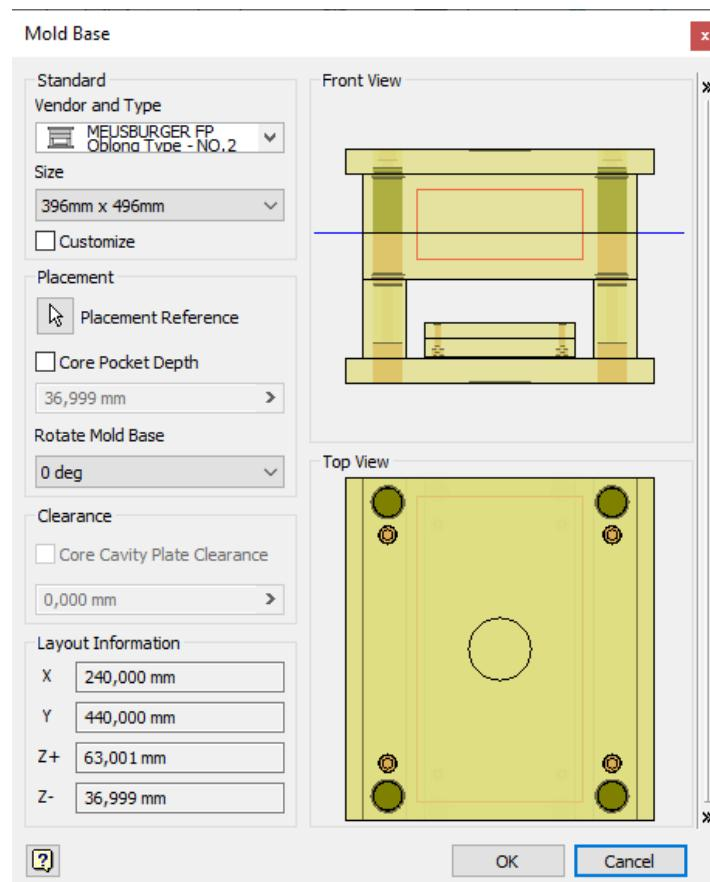
Slika 4.3. Odabrani standardni tip kućišta kalupa
