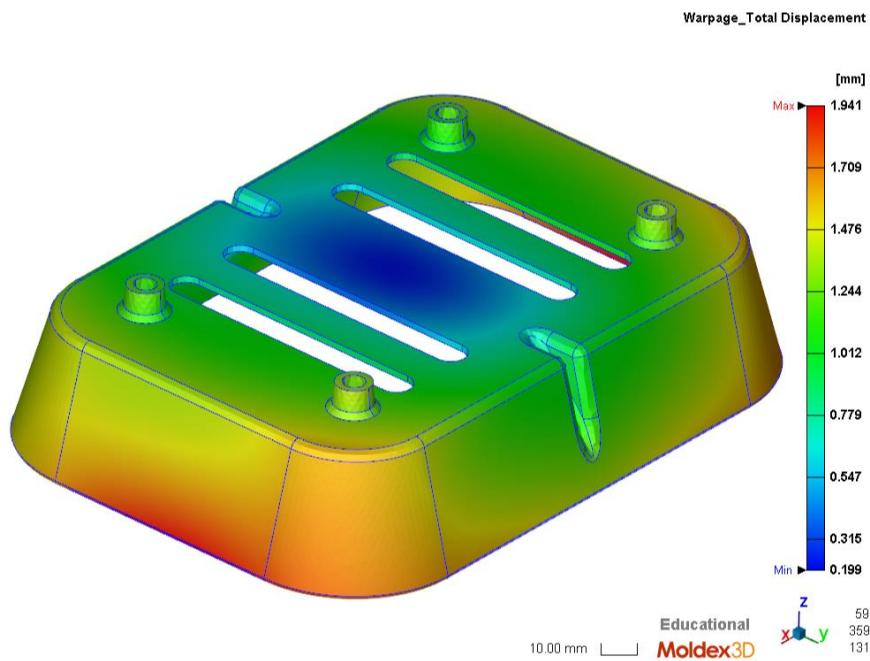
Slika 6.13. Deformacije otpreska nakon vađenja iz kalupa
