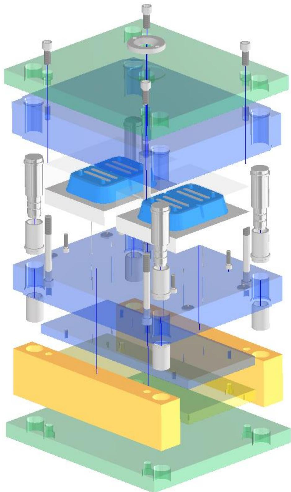
Slika 4.9. Detaljni prikaz dijelova kalupa za injekcijsko prešanje posudice za sapun
