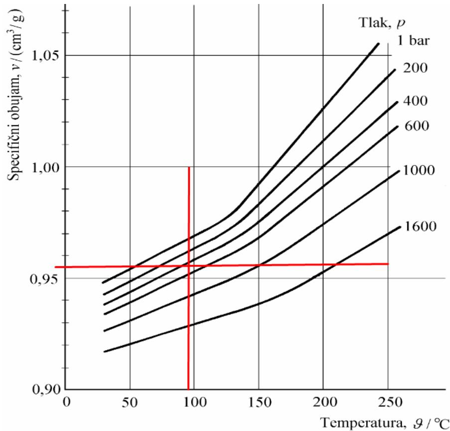
Slika 5.1. Dijagram  $p$ - $v$ - $T$  ABS Terluran
