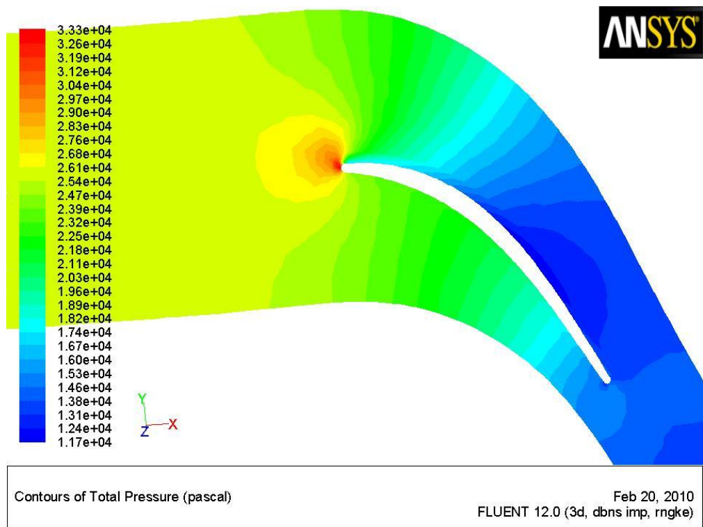
Slika 6.20. Prikaz raspodjele totalnog tlaka na vanjskom promjeru rotorske lopatice
