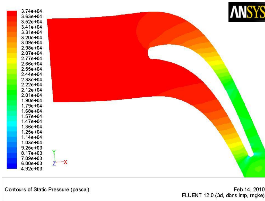
Slika 6.7. Prikaz raspodjele statičkog tlaka na srednjem promjeru statorske lopatice
