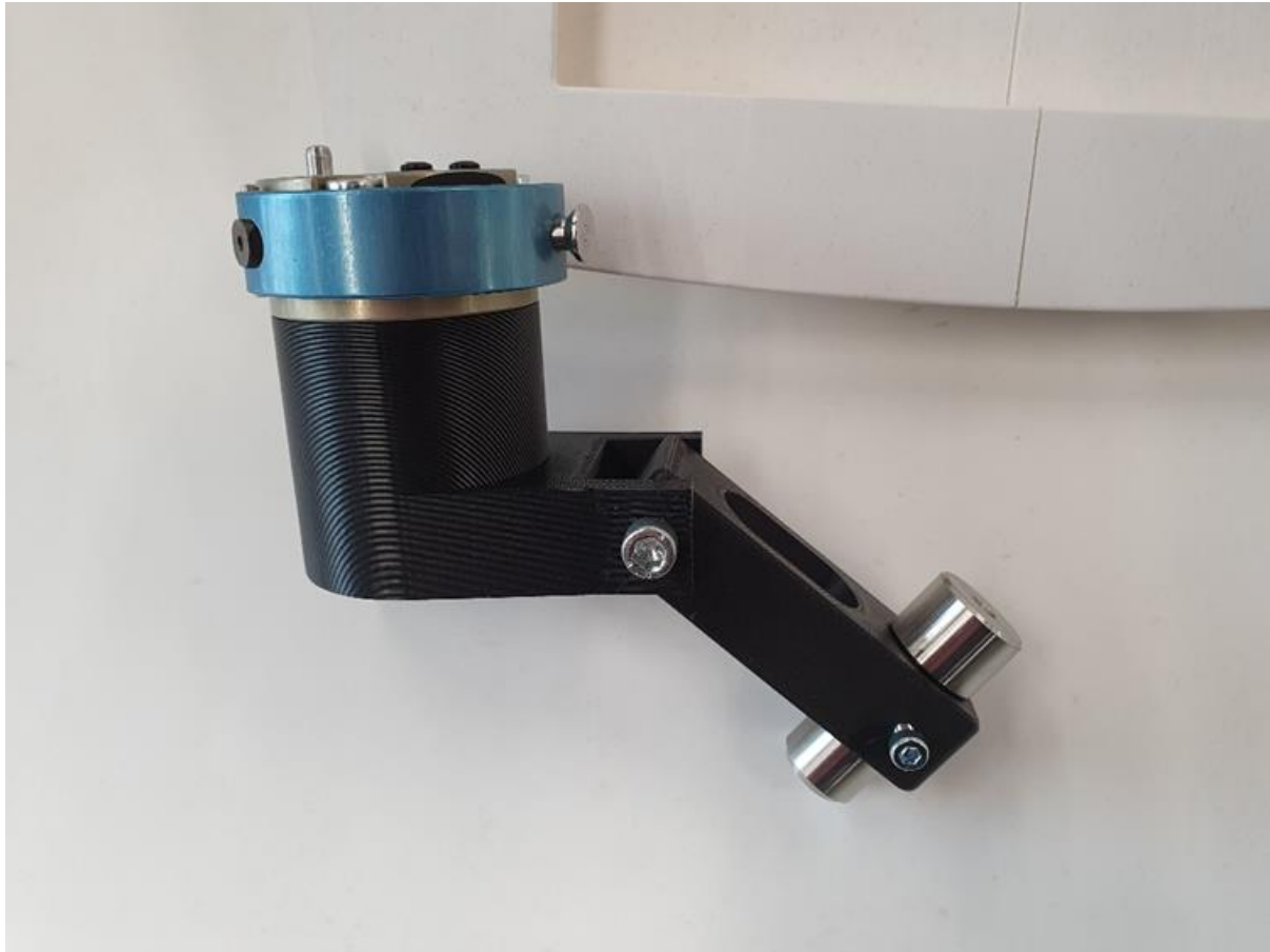
Slika 29. 3D print konstruiranog modularnog alata
