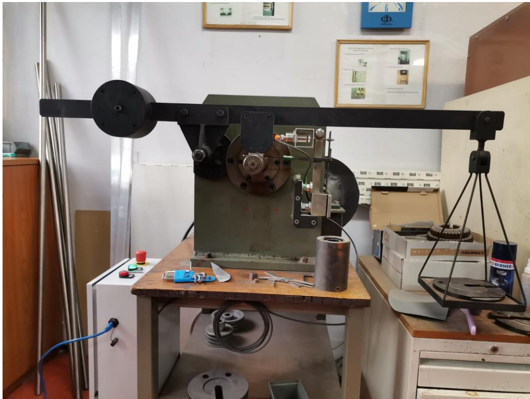
Slika 7.15 Uređaj za ispitivanje faktora trenja (adhezijskog trošenja) na Fakultetu strojarstva i brodogradnje u Zagrebu
