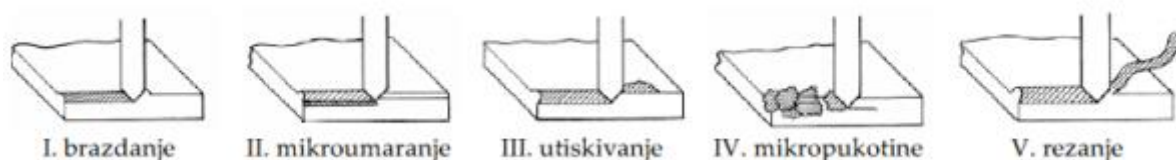
Slika 2.7 Načini abrazijskog trošenja [3]
