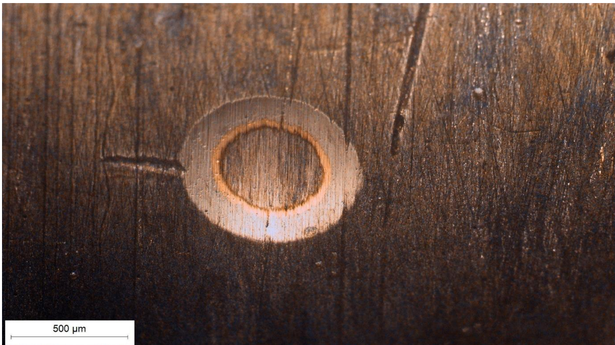
Slika 7.13 Otisak nakon ispitivanja TiN/TiCN prevlake
