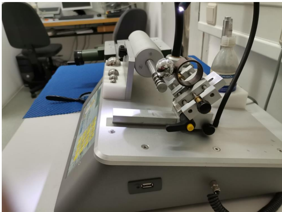
Slika 7.11 Ispitivanje debljine TiN/TiCN prevlake kalotestom
