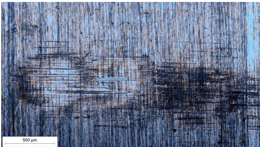
Slika 7.19 Prikaz traga trošenja nakon ispitivanja tribopar „100Cr6 - 100Cr6“
