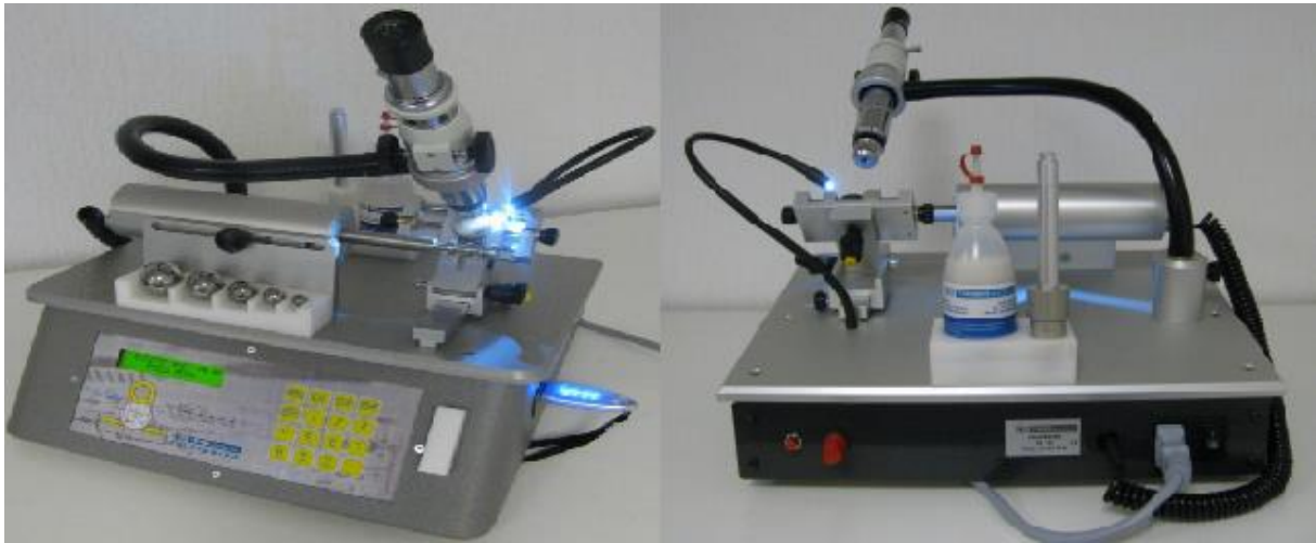
Slika 5.5 Kalotest uređaj na Fakultetu strojarstva i brodogradnje u Zagrebu tvrtke TRIBOtechnic [28]
