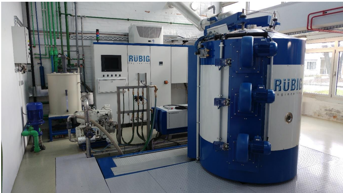
Slika 4.5 PACVD uređaj na Fakultetu strojarstva i brodogradnje tvrtke Rübzig GmbH
