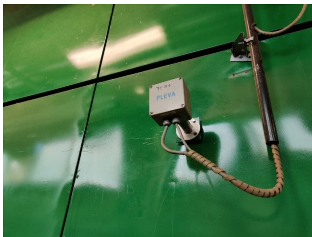
Slika 65. Senzor za očitavanje sadržaja vodene pare unutar sušare
