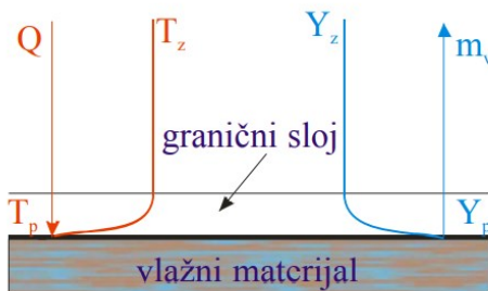
Slika 5. Prikaz prijelaza tvari i topline tijekom perioda konstantne brzine sušenja [1]
