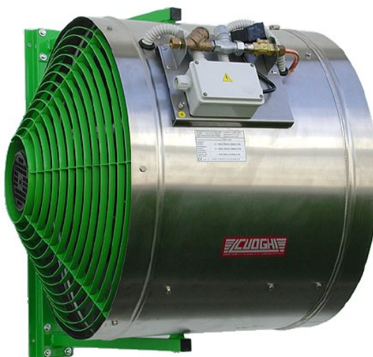
Slika 21. Prikaz industrijskog uređaja za ovlaživanje zraka [8]
