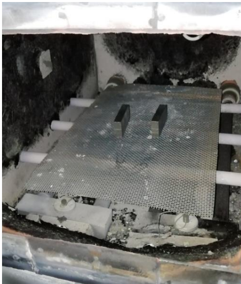
Slika 25. Postavljanje ispitnih uzoraka u vakuumsku peć
