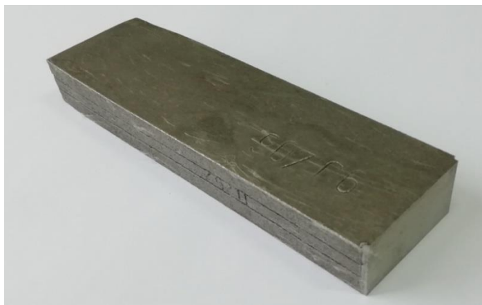
Slika 22. Odljevak nehrđajućeg dupleks čeličnog lijeva iz kojeg su izrezani uzorci
