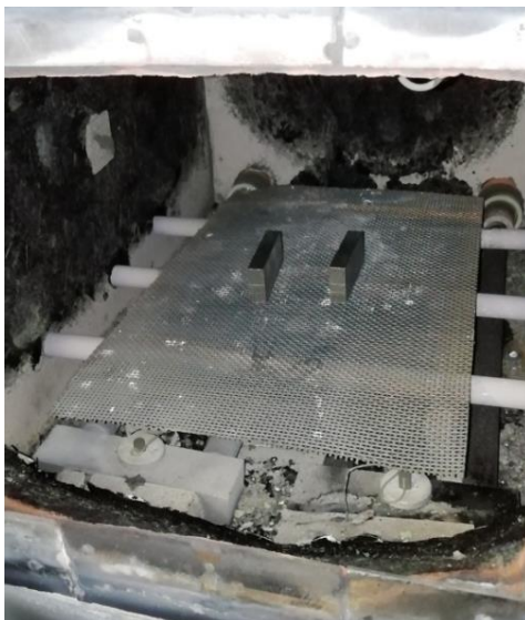
Slika 25. Postavljanje ispitnih uzoraka u vakuumsku peć
