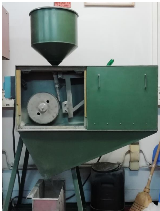
Slika 29. Uređaj za ispitivanje otpornosti na abrazijsko trošenje
