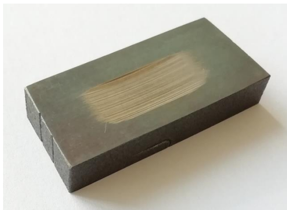
Slika 31. Trag trošenja na uzorku
