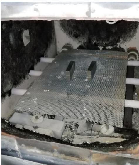
Slika 25. Postavljanje ispitnih uzoraka u vakuumsku peć
