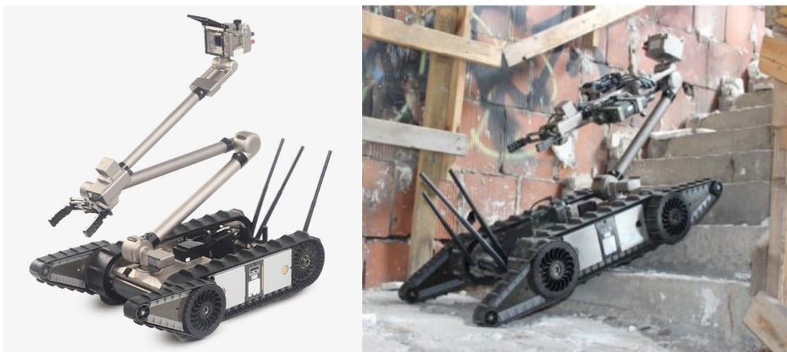
Slika 2.2. Packbot bez i sa stražnjim „gusjenicama“
