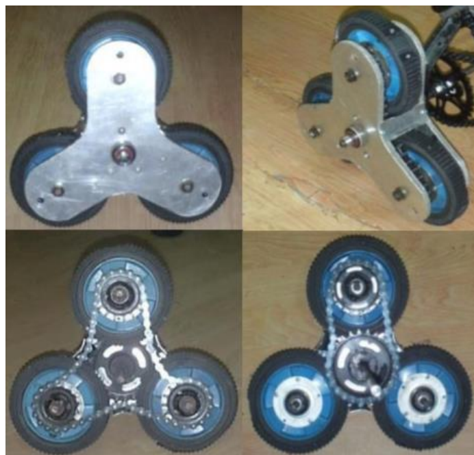
Slika 3.4. Sklop i pogon kotača u trokutnoj konfiguraciji[13]
