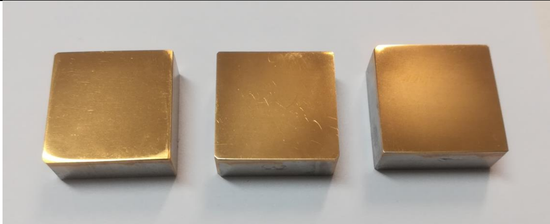
Slika 23. Uzorci prevučeni TiN prevlakom
